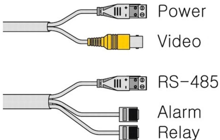
Схема подключения видеокамеры VPD360S3-O
