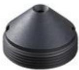
В стандартном исполнении видеокамеры установлен микро объектив Р типа с фокусным расстоянием 3.7 мм и относительным отверстием F2.0. Возможные варианты оптики: Плоский объектив 3.4 (100°), 3.7 (90°); усеченный конус 3.7 (90°), 5.0 (60°); полный конус 2.8 (120°).
