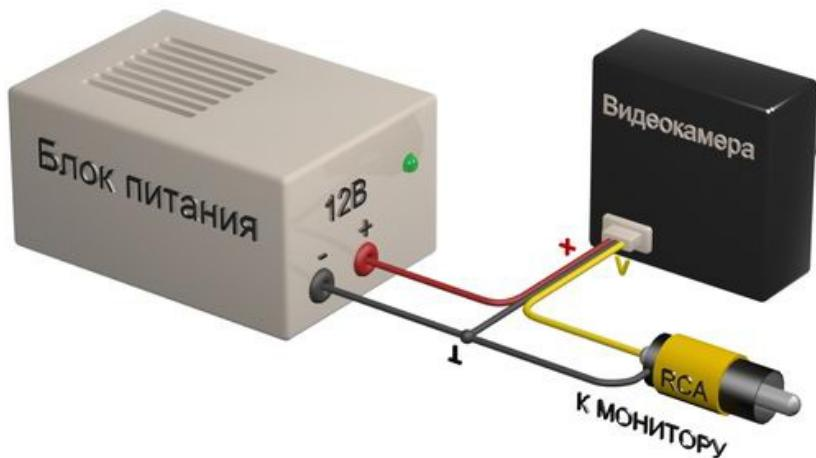
**Схема подключения видеокамеры VQ33CSHRX-P37P**
