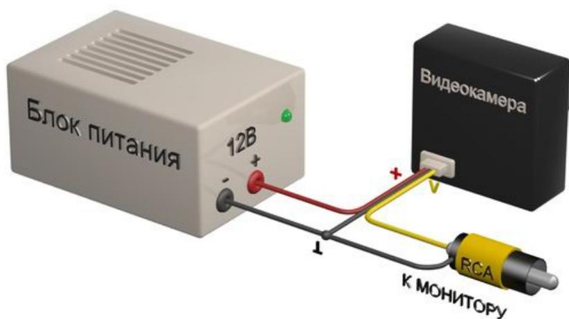
Схема подключения видеокамеры VQ293CH-B12(PAL)
